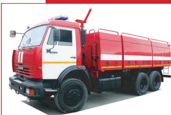
Автомобиль порошкового тушения на шасси КАМАЗ-65115 предназначен для доставки к месту пожара боевого расчета, пожарно-технического вооружения и огнетушащего порошка в объеме 5000 кг.
