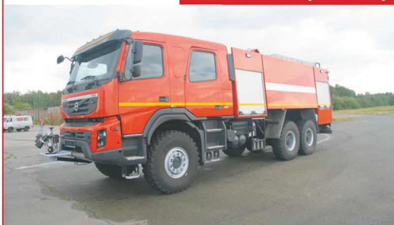
Аэродромный пожарный автомобиль на шасси, которое изготовлено на заводе в Швеции, VOLVO FM 480. С двойной кабиной, автоматической коробкой передач. Мощность двигателя — 480 л. с. Емкость цистерны для воды — 9,0 м<sup>3</sup>, производительность насоса — 65 литров в секунду. Максимальная скорость — 120 км/час. Это соответствует всем международным требованиям к аэродромным пожарным автомобилям.
