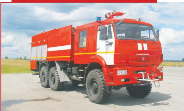
Аэродромный пожарный автомобиль на шасси КАМАЗ-65224 с емкостью цистерны для воды 9,0 м<sup>3</sup> и производительностью насоса 65 литров в секунду. Мощность двигателя — 400 л. с.
