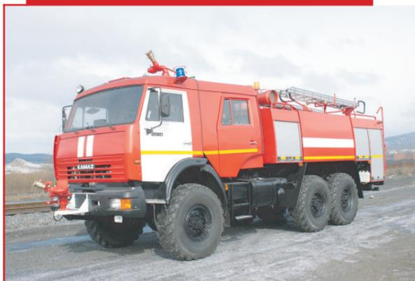
Аэродромный пожарный автомобиль на шасси КАМАЗ-43118 с емкостью цистерны для воды 8,5 м<sup>3</sup> и производительностью насоса 65 литров в секунду. Мощность двигателя — 300 л. с. Укомплектован всем оборудованием российского производства, кроме насоса.
