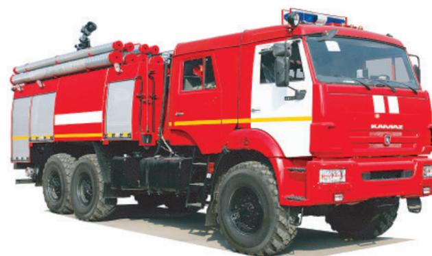
Автоцистерна пожарная на шасси КАМАЗ-43118 с емкостью цистерны 5,0 м<sup>3</sup> и насосом производительностью 100 литров в секунду. Мощность двигателя — 300 л. с. Машина разработана по техническим требованиям ОАО «Транснефть» и предназначена для работы в его подразделениях на нефтеперекачивающих станциях. Автомобиль укомплектован специальными дозирующими системами пенообразователя, лафетными и ручными стволами американского производства.
