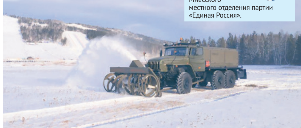
Уникальная спецтехника производства ООО «Завод СпецАгрегат» способна убирать до трех тысяч тонн снега в час.
