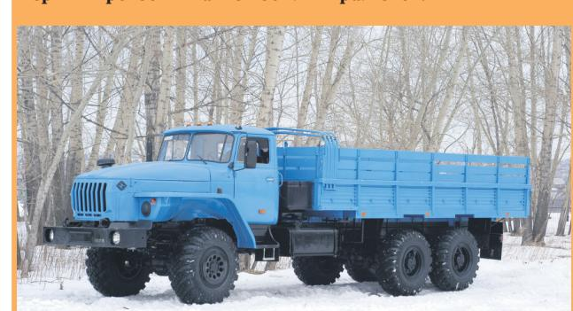
Автомобили с дизельным двигателем «Урал-4320»
