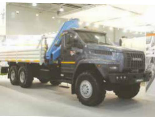
На выставке экспонируется представитель полноприводного семейства «Урал NEXT» с колесной формулой 6x6. Это новая модификация с монтажной длиной рамы 7 м, что позволило разместить кран-манипуляторную установку и бортовую платформу длиной 6 м. Таким образом, был значительно повышена эффективность транспортного средства: автомобиль получил возможность погрузки-разгрузки и перевозки различных длинномерных грузов.
