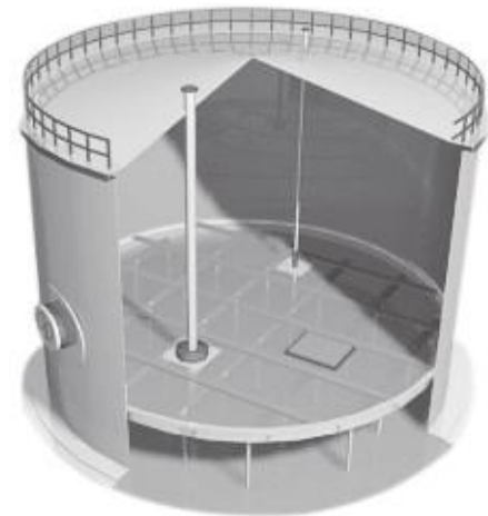
Понтон АО «ММЗ» — плавающее покрытие на зеркале нефтехимического продукта в резервуаре.
