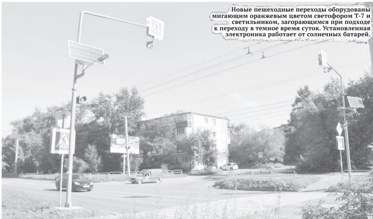
Новые пешеходные переходы оборудованы мигающим оранжевым цветом светофором Т-7 и светильником, зажигающимся при подходе к переходу в темное время суток. Установленная электроника работает от солнечных батарей.
